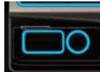
Los terminales frontales USB y AUX están iluminados para facilitar la conexión en la oscuridad, y protegidos contra el polvo por una cubierta deslizante.
