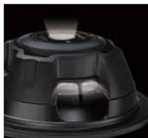
La efectiva disipación de calor y reproducción de graves se consigue con un orificio situado en el lado del marco y el imán, así como en el centro de la superficie trasera. Gracias a estas rejillas de ventilación en las superficies laterales y traseras se consigue una reducción de tamaño resultando de ello una caja de woofer más delgada.
